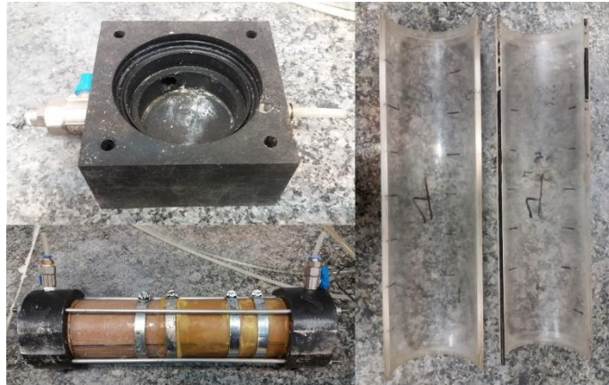
شکل ۳. تصویر قالب دوتکه، محفظه‌ی قرار گرفته در دو سر قالب برای تزریق و نمونه آماده تزریق Fig. 3. The picture of two slice mold and two caps at the endings to inject the prepared sample
