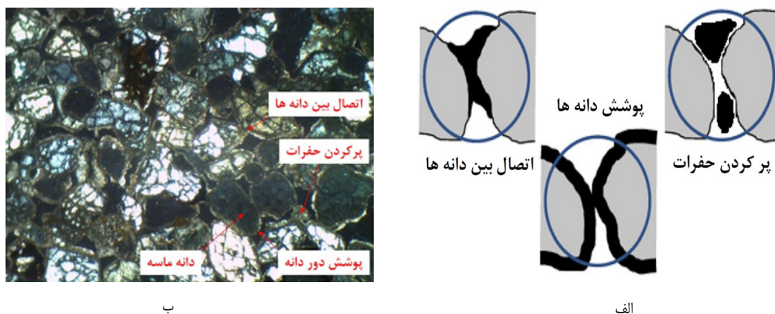
شکل ۷: الف) جانمایی کلی رسوب کلسیت در بهسازی زیستی، ب) عکس میکروسکوپی مقطع نازک خاک بهسازی شده
