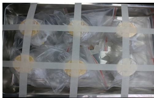
شکل ۲: نمونه‌های مخلوط با شیرابه برای آزمایش بلند مدت
