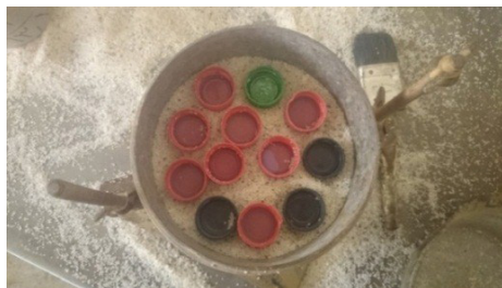
شکل ۵: آماده سازی نمونه مسلح شده با ترکیب لایه‌ای Fig. 5. Preparing reinforced sample with layer combination
