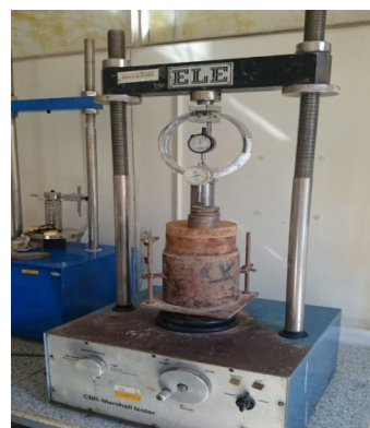
شکل ۶: نمونه آزمایش در حین بارگذاری با استفاده از سربار
