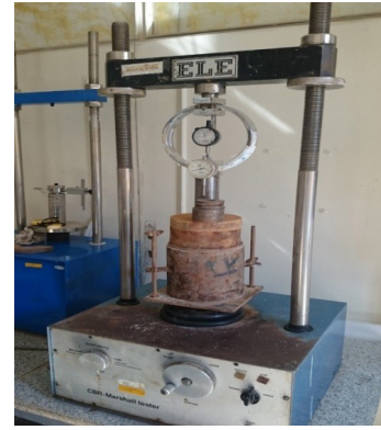
شکل ۶: نمونه آزمایش در حین بارگذاری با استفاده از سر بار
