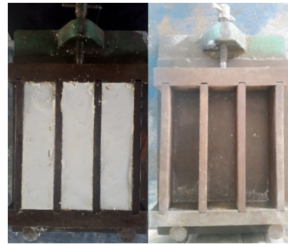
شکل ۵: قالب آزمون خمشی قبل و بعد از پر شدن
