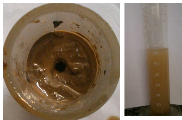
شکل ۴: کیفیت آب خروجی از نمونه و اندازه قطر سوراخ در پایان آزمایش با ۱٪ وزنی نفت و آغشته به محلول ۱۲٪ هگزامتافسفات سدیم
