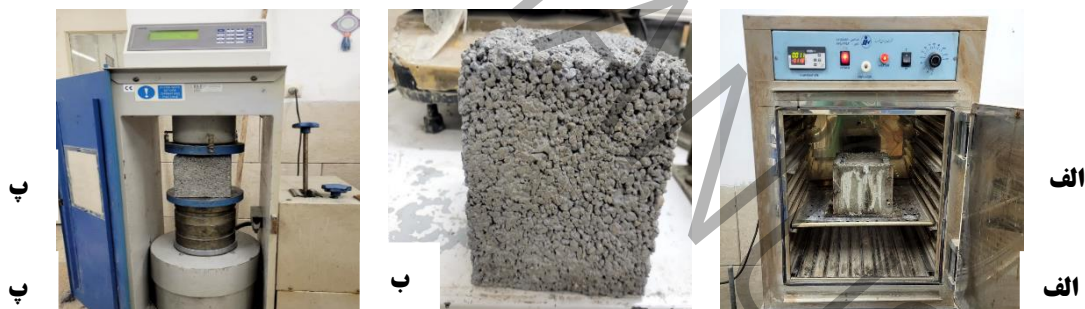
شکل ۱۵. الف) آزمون مکعبی در آون ب) آزمون بعد از خروج از آون پ) شکست آزمون با دستگاه مقاومت فشاری.
