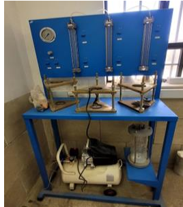
شکل ۱۴. دستگاه نفوذپذیری بتن.
