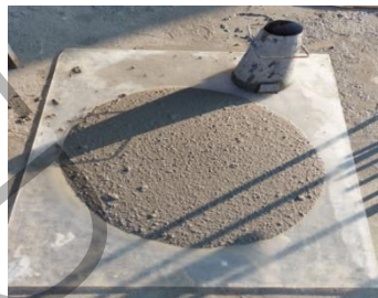
شکل ۷. آزمایش جریان اسلامپ
