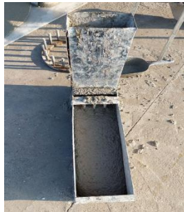
شکل ۹. آزمایش جعبه L Figure 9. L box test
