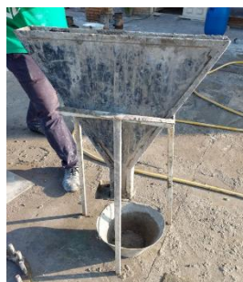
شکل ۸. آزمایش قیف V
