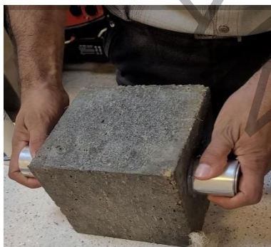
شکل ۱۳. آزمایش سرعت پالس آلتراسونیک بر روی نمونه.
