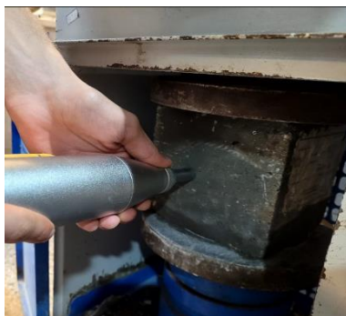
شکل ۱۲. آزمایش چکش اشمیت بر روی نمونه.
