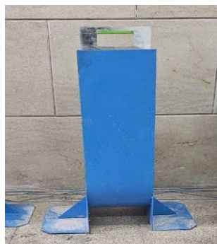
شکل ۱۱. آزمایش جعبه U Figure 11. U box test
