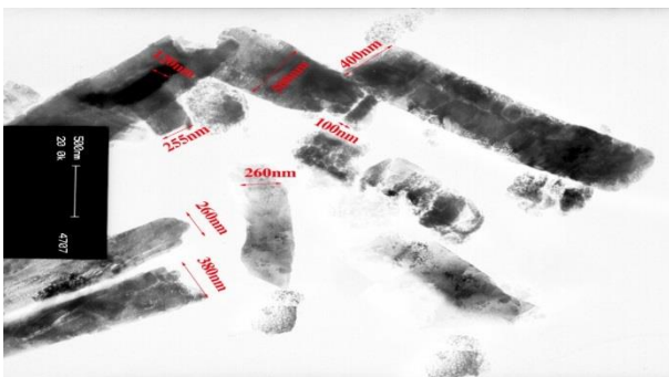
شکل (۱): عکس میکروسکوپی (TEM) از ذرات نانولاستونیت
