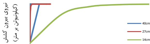
شکل (۱۹): ژئوگرید «در حالت کاملاً درشت‌دانه» جابه جایی در طول ژئوگرید (میلیمتر)
