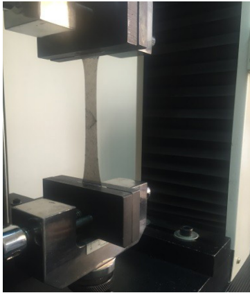
شکل ۳: (راست) نمونه الیاف پلاستیکی در آزمون کشش (چپ) منحنی های نیرو تغییر شکل الیاف
