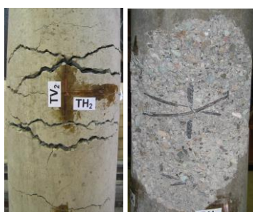
الف) دورپیچ متقاطع با چرخش ۹۰ درجه
