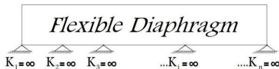
شکل (۲): تیر ارتجاعی بر روی تکیه‌گاه‌های صلب
